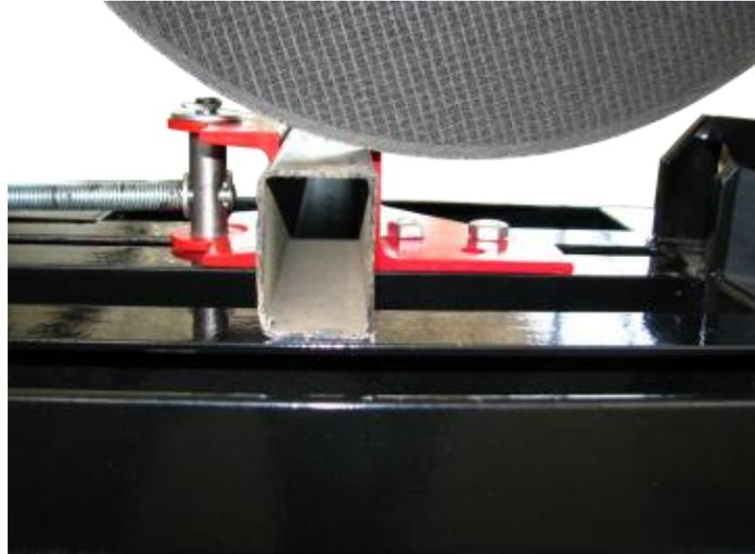
Абразивный диск снимается двумя гаечными ключами 19 и 27
