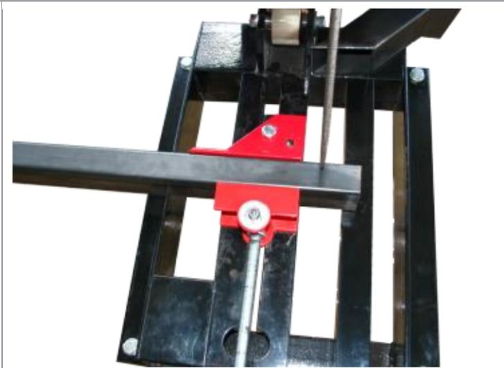
Кроме того для настройки входа абразивного отрезного диска при резке в конструкции предусмотрена регулировка положения задней губки тисков.
