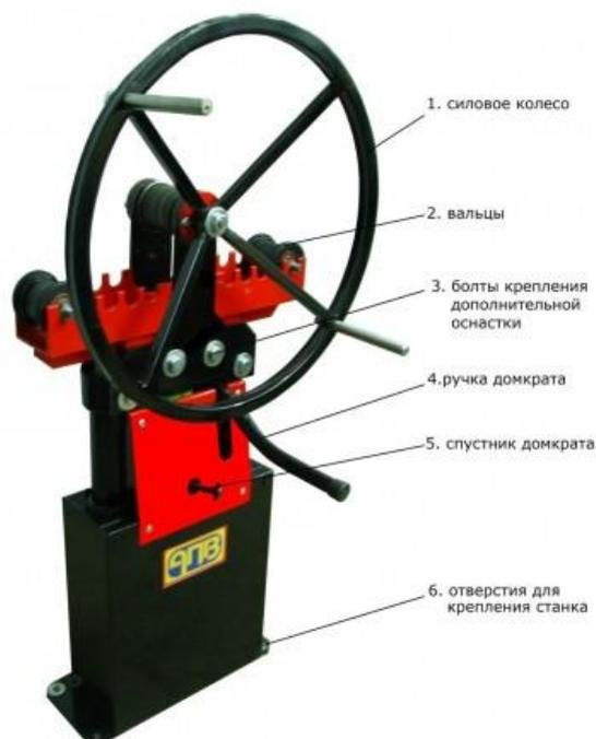
Профилегиб отличается простотой работы благодаря использованию в конструкции станка гидравлического домкрата.
