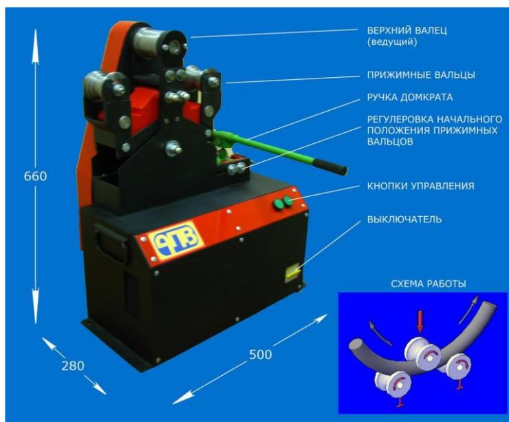
Станок предназначен для радиусной гибки профильных труб, труб круглого сечения, полосы, прутка, алюминиевого профиля.
